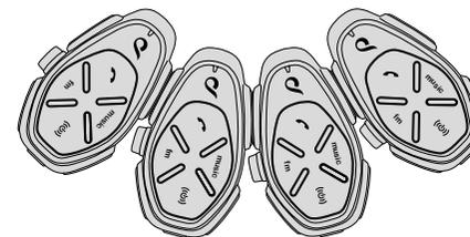
2. Sulla prima unità di sinistra, premere ((P)) fino a che il led lampeggerà rosso/blu. La procedura si concluderà automaticamente, quando anche l'ultima unità sarà tornata in modalità stand-by (led blu ogni tre secondi). Tutte le centraline ora sono abbinata.
