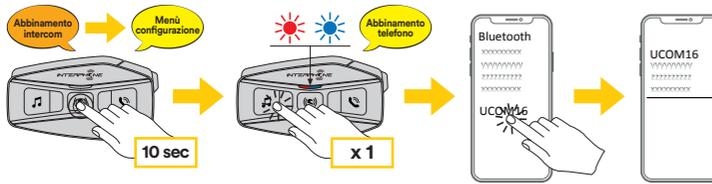
Abbinamento secondo telefono (da eseguire a centralina accesa)
