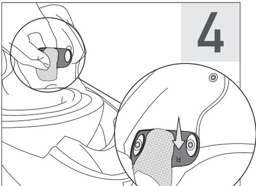
Inserire l'auricolare destro nell'apposito alloggiamento facendolo coincidere con le clip del casco
