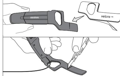
Rimuovere la pellicola protettiva ed applicare il velcro™ sul microfono, accorciare il microfono tagliando in corrispondenza della scanalatura
