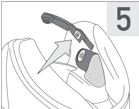
Applicare il microfono al casco facendo coincidere il foro con la clip dell'imbottitura
