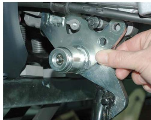
8. A questo punto inserire il primo perno filettato di sicurezza in dotazione, con la sua rondella attraverso le piastre, nel foro del cavalletto. Vedi foto
