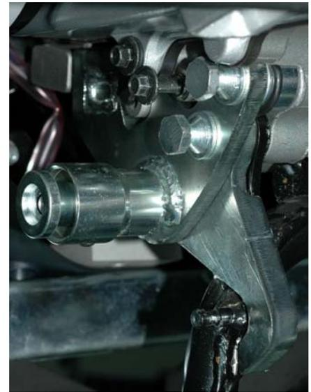
11. Verificare con attenzione che l'oscillazione del cavalletto avvenga senza impedimenti, qualora tale movimento di oscillazione risultasse frenato (frizione tra le piastre), inserire una rondella (10x30x1), non in dotazione, tra il carter motore e la boccola originale di sostegno del cavalletto, in modo da eliminare il gioco assiale del cavalletto (vedi figura n. 2: l'esplosivo di montaggio).
