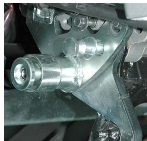
9. Inserire la boccola con l'OR (facendo attenzione che l'OR sia rivolto verso il lato sinistro del veicolo) dietro la piastra mobile in corrispondenza dell'altro foro ed avvitare l'altro perno di sicurezza con rondella in dotazione. Vedi Foto
