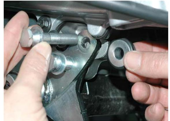
10. Serrare entrambi i perni in maniera **alternata** fino ad arrivare alla fine della loro corsa, **senza spezzare ancora la testa**. Vedi foto.
